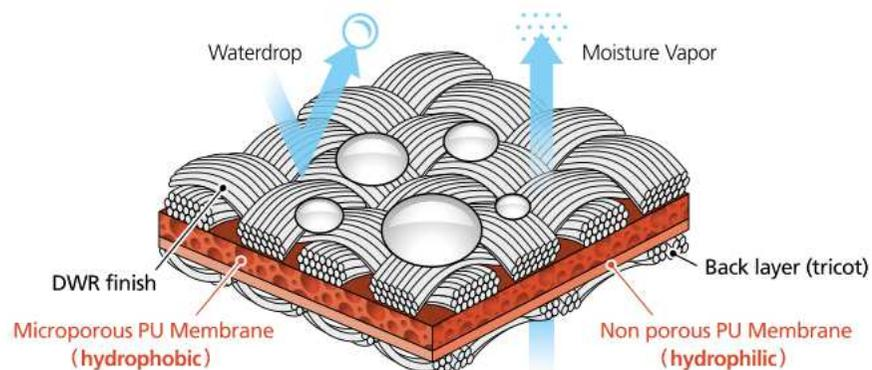
Si tratta di un tessuto 3 strati altamente impermeabile e traspirante. Il tessuto esterno è un 100% nylon fermo estremamente resistente ma che, allo stesso tempo, mantiene una piacevole mano naturale. Grazie alla membrana "ibrida" Dermizax HB – che unisce i vantaggi delle membrane microporose e di quelle monolitiche – si hanno performances di livello premium, studiate appositamente per il "sailing":
